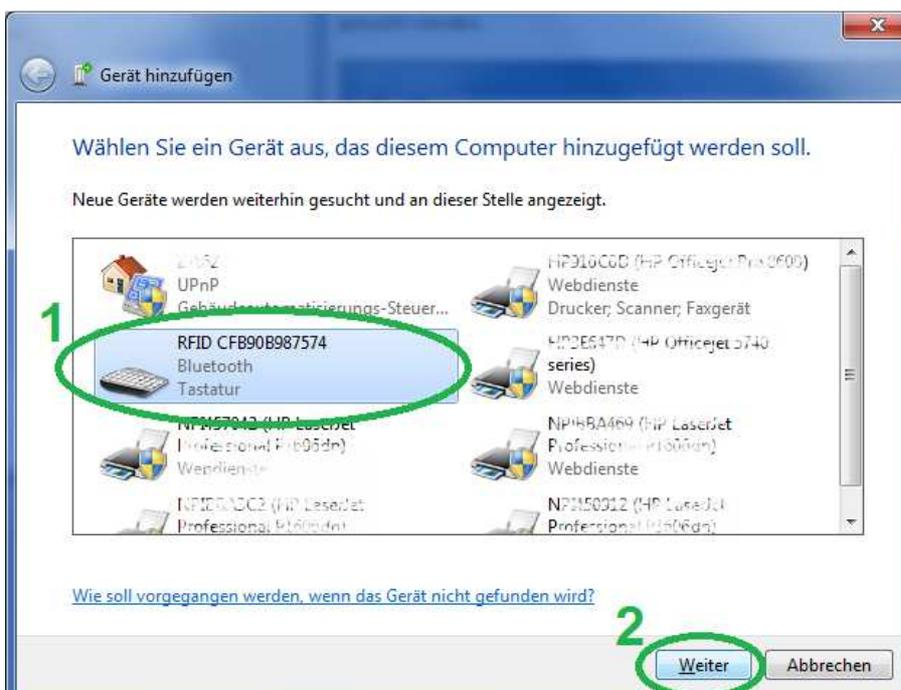
Wurde das ARE H9 gefunden, ist es auszuwählen und über die Schaltfläche **Weiter** wird der PC versuchen die Verbindung zum ARE H9 herzustellen.
