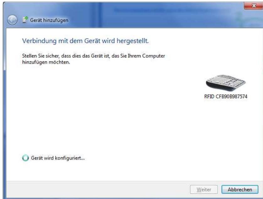
Wurde die Verbindung zum ARE H9 erfolgreich hinzugefügt, können ab nun Transpondercodes wie Tastatureingaben in geöffnete Eingabe oder Textfelder des verbundenen Geräts übertragen werden.
